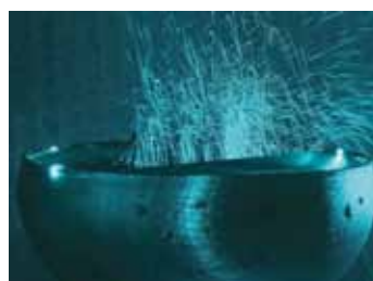
Figure 5 : Photographie utilisant la tomographie laser et mettant en évidence les jets de liquide résultant de l'éclatement de myriades de bulles à la surface d'une coupe de Champagne. Cette photo a fait la page de couverture du numéro de novembre 2008 de la revue Chemical Society Reviews. (Photos : professeur G. Liger-Belair, F. Beaumont et professeur G. Polidori)
